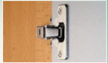
ด้วย หัวปีกสันบากหลายตัวได้หัวสกรู MULTI head ป้องกันไม่ให้สกรูขันลึกจนเกิน ไป ทำให้บานพับที่ขันยึดติดแน่นพอดี
